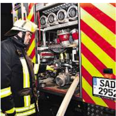
Die Pumpe förderte das Löschwasser zum Strahlrohr.
